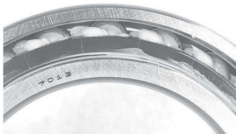
Abb. 1.20: befülltes Zylinderrollenlager
