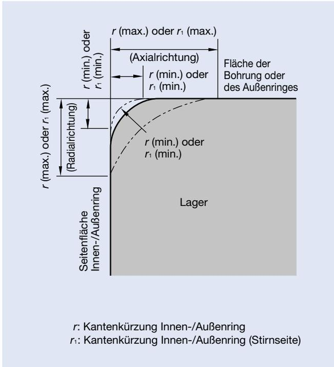
**Anmerkungen:** Die genaue Form der Radien ist nicht festgelegt, aber das Profil in der Axialebene darf einen Bogen mit Radius  $r$  (min.) oder  $r_1$  (min.) nicht überschreiten, der zwischen der Stirnfläche des Innenrings und der Bohrung bzw. der Stirnfläche des Außenrings und der Mantelfläche des Außenrings liegt.
