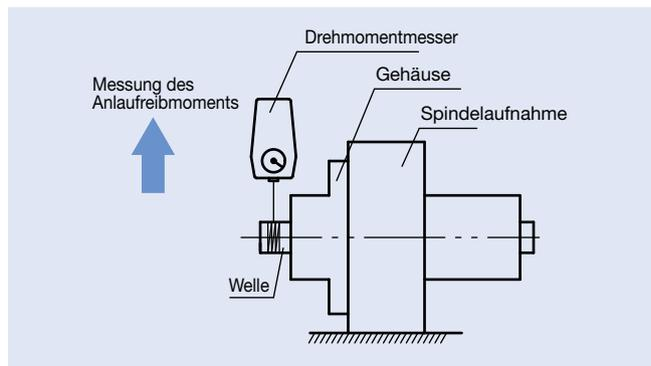
Abb. 1.24: Verhältnis von Anlaufreibmoment und Vorspannung
