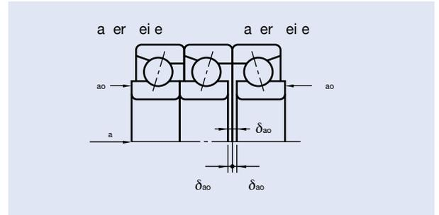
Abb. 4.4: Axiale Einfederung einer DBD-Lageranordnung mit Vorspannung
