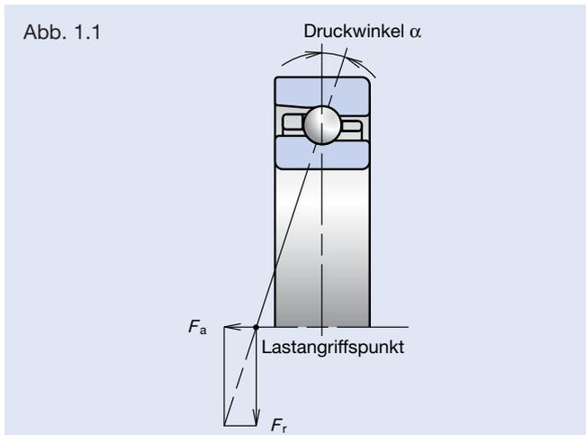
Abhängig vom Druckwinkel ergeben sich in einem Schrägkugellager bei gleicher äußerer Belastung unterschiedliche elastische Verformungen und Spannungen in den Kontaktstellen an Innen- und Außenring.
