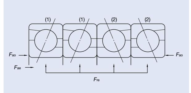
Bei externer Radialbelastung  $F_{re}$  errechnet sich die gesamte Vorspannung  $F_{ap}$  wie folgt:
