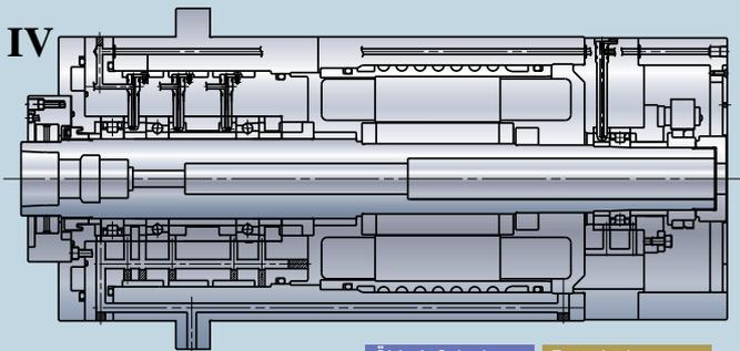
Öl-Luft-Schmierung  $nxd_m \nearrow 2,2M$  Fettschmierung  $nxd_m \nearrow 1,3M$
