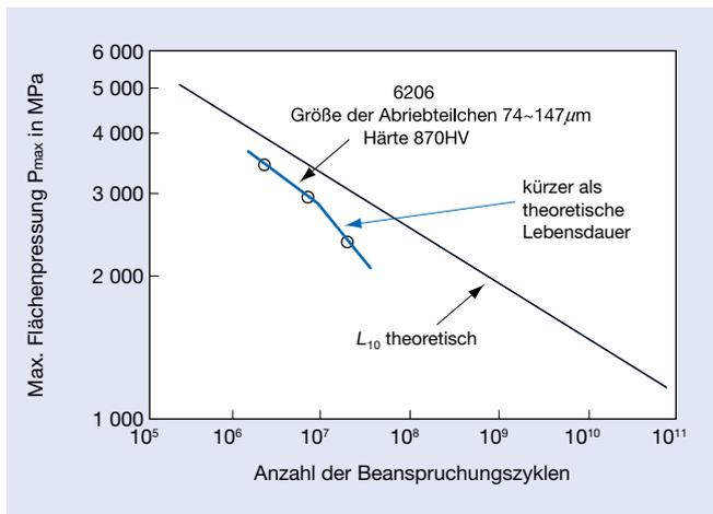
Die neue NSK Lebensdauerrechnung berücksichtigt den Verlauf der Lebensdauerwerte aus den Tests bei sauberem Schmierstoff und geringer Belastung.
