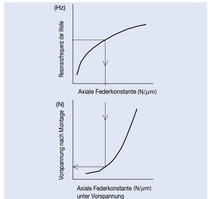
Messung der Resonanzfrequenz ( $F_z$ ) der Welle in axialer Richtung
