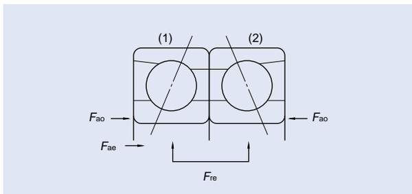
Bei externer Radialbelastung ( $F_{re}$ ), errechnet sich die gesamte Vorspannung ( $F_{ap}$ ) wie folgt:
