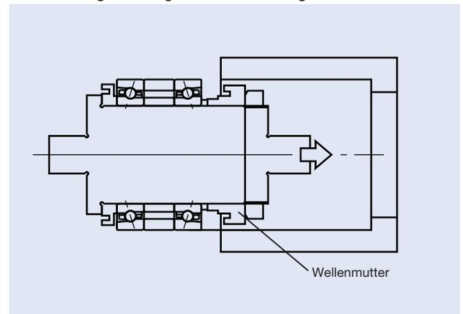
Abb. 1.5: Lagermontage für X-Anordnung
