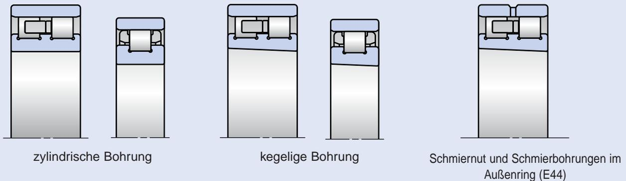
Ein- und zweireihige Lager sind mit zylindrischer oder kegeliger Bohrung verfügbar. Bei zweireihigen Zylinderrollenlagern ist die Ausführung mit Schmiernut und Schmierbohrungen für Ölschmierung zu bevorzugen.
