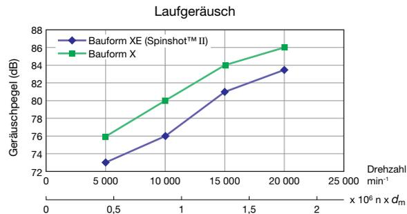
Entwickelt für hohe Drehzahlen und hohe Steifigkeiten
