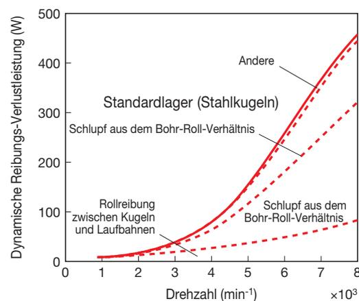
Erwärmung des Außenrings bei hohen Drehzahlen
