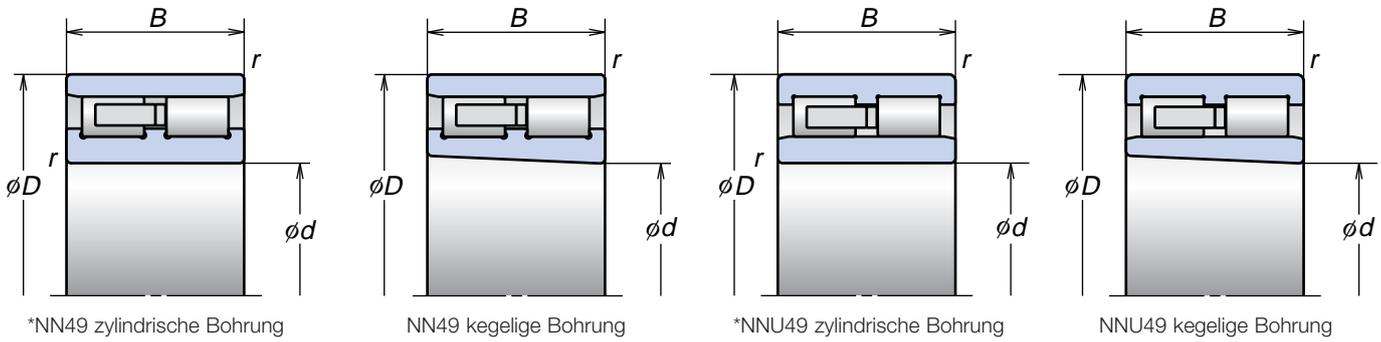
\*NN49 zylindrische Bohrung
