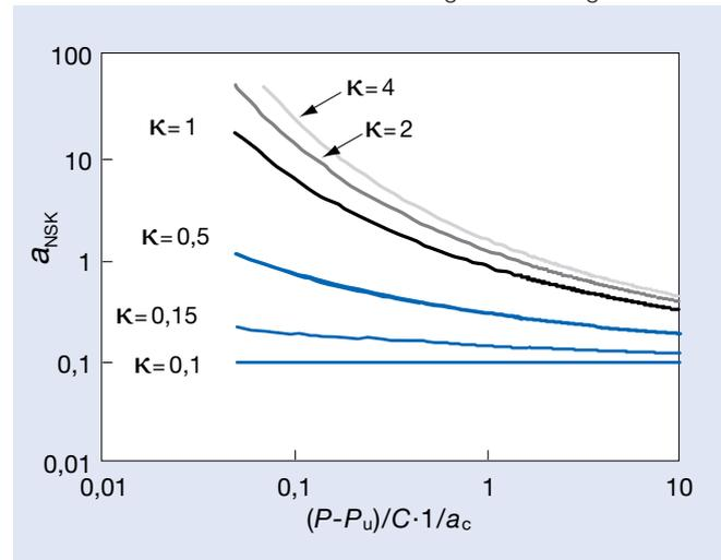
Die Diagramme beziehen sich auf NSK Genauigkeitslager aus Standard-Z-Stahl mit Fettschmierung oder mit Schmierstoff der Viskosität VG22 bis VG68 in sauberer Umgebung.
