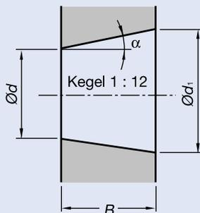
$d$  : Nennendurchmesser der Bohrung
