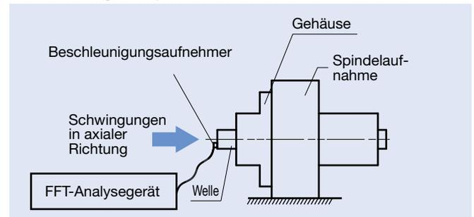
Abb. 1.28: Verhältnis von Eigenfrequenz der Hauptwelle und Federkonstante
