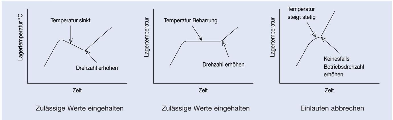
Die Drehzahl kann erhöht werden, wenn der Temperaturanstieg innerhalb der zulässigen Werte liegt.
