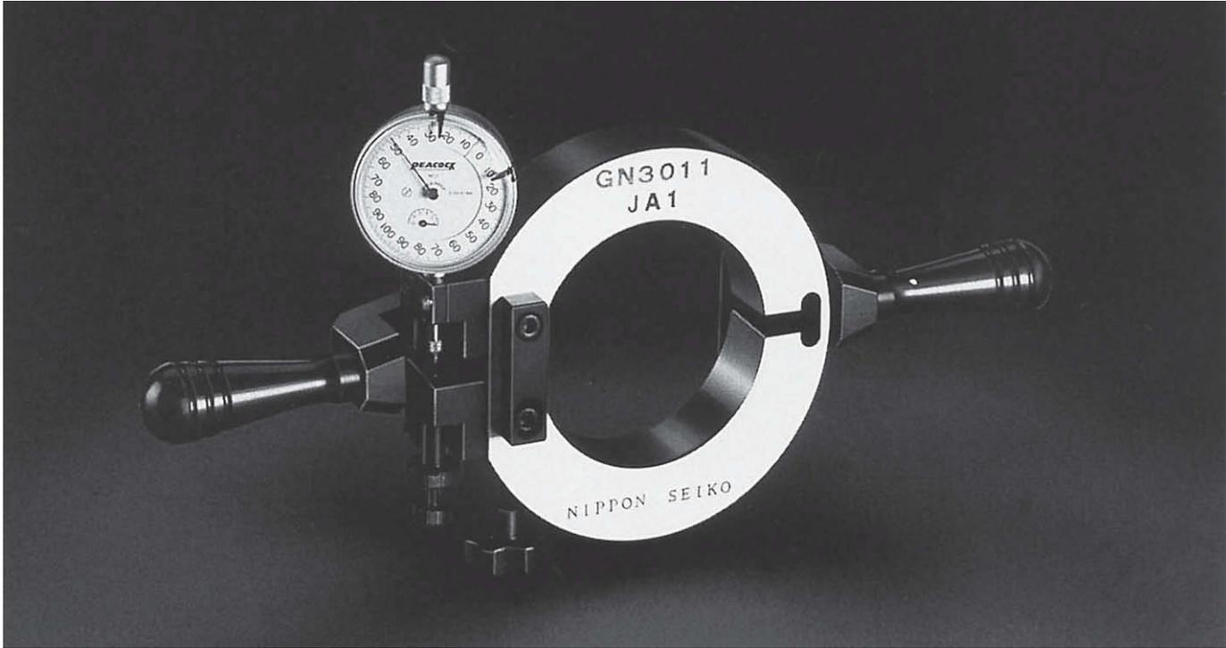
Beim Einbau eines zweireihigen Zylinderrollenlagers mit kegeliger Bohrung muss die Kegelsteigung von Welle und Lagerbohrung genau übereinstimmen. Außerdem muss die erforderliche Lagerluft nach der Montage genau eingestellt werden.
