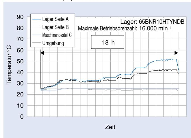
Abb. 2.2: Anstieg der Betriebstemperatur im Dauerlauf (°C)
