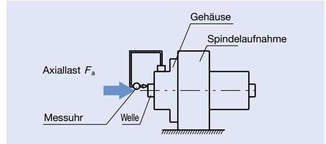
Abb. 1.26: Verhältnis von axialer Einfederung und Vorspannung
