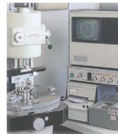
Rundheitsmessgerät mit hoher Vergrößerung (200 000-fach)
