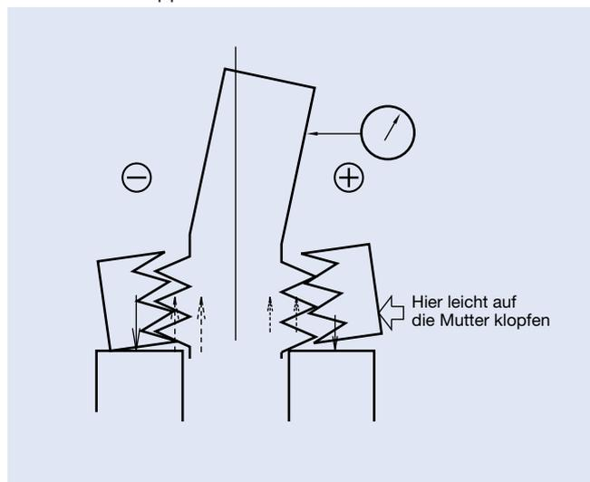
Abb. 1.22: Laufgenauigkeit einer Werkzeugmaschinen spindle
