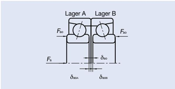
Abb. 4.4: Axiale Einfederung einer DB-Lageranordnung mit Vorspannung
