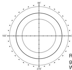
Rundheit eines geschliffenen Werkstückes
