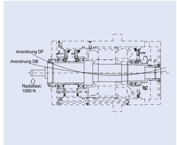
Abb. 3.6: Anordnungen von Schrägkugellagern
