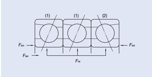
Bei externer Radialbelastung  $F_{re}$  errechnet sich die gesamte Vorspannung  $F_{ap}$  wie folgt:
