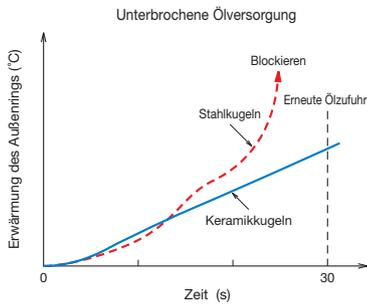
Zerspanung mit einer NSK-Spindel die mit Keramikugeln ausgerüstet ist
