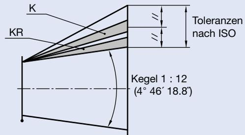
**K:** Die NSK-eigene Toleranz für kegelige Bohrungen hat einen eingeeengten Toleranzbereich, der etwa in der Mitte des Toleranzbereichs der ISO-Norm liegt. Die Toleranzen der Bohrung entsprechen ISO.
