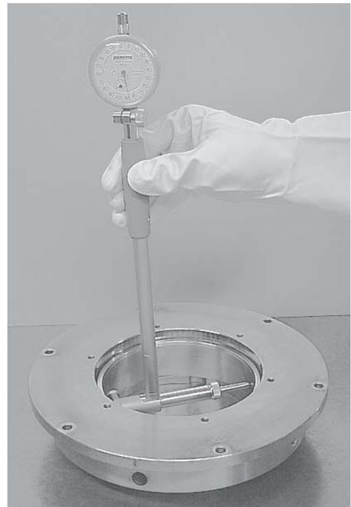
Abb.1.11: Laufbahndurchmesser des Außenrings auf das GN-Hüllkreismessgerät übertragen
