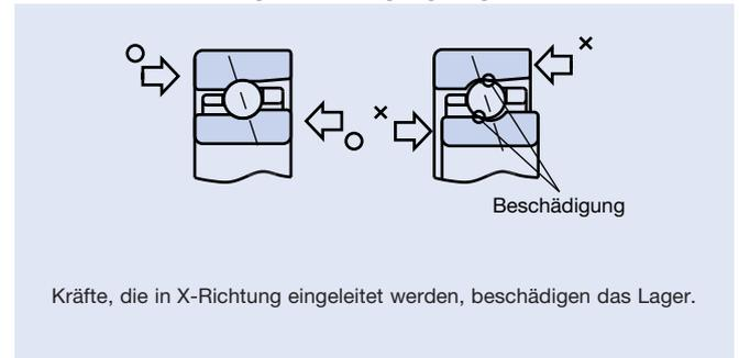
Abb. 1.4: Lagermontage für O-Anordnung
