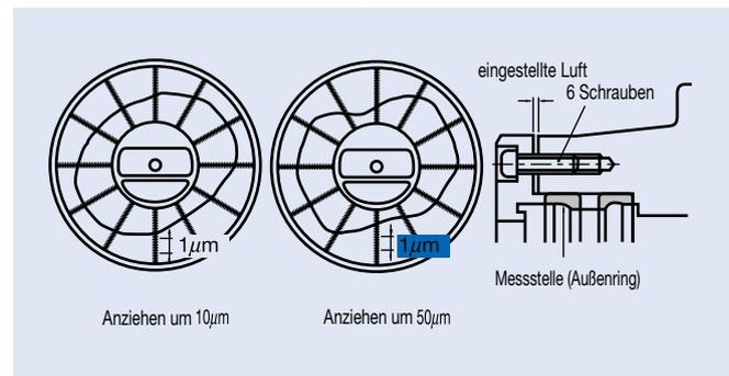
Abb. 1.8: Verformung des Außenrings eines zweireihigen Zylinderrollenlagers durch übermäßiges Anziehen der Befestigungsschrauben
