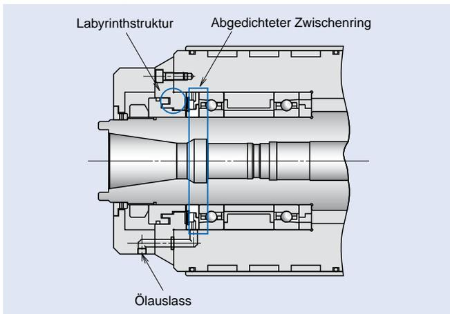
In dem Beispiel in der Abbildung links ist eine dreifache Dichtungsausführung zu sehen. Die Labyrinthdichtung besteht dabei aus dem Gehäusedeckel und dem Innenzwischenring als erster Dichtung, gefolgt von dem abgedichteten Präzisionszwischenring mit einer zusätzlichen integrierten Labyrinthdichtung.
