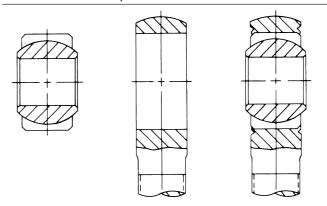
FIGURE 5 - 3- PIECE, HOUSING STAKED ROD END
