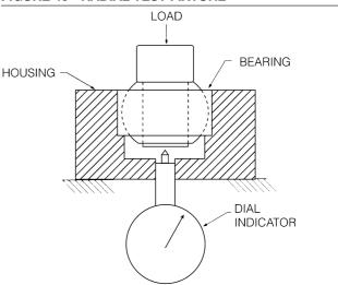
FIGURE 41 - AXIAL TEST FIXTURE
