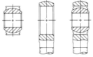
FIGURE 4 - 3- PIECE, V-GROOVE STAKED ROD END
