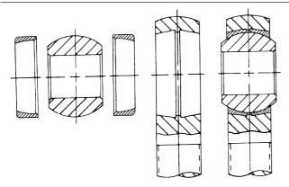
FIGURE 3 - 4- PIECE, INSERT-TYPE ROD END
