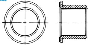
**FIGURE 13 - FLANGE, TEFLON LINED**
