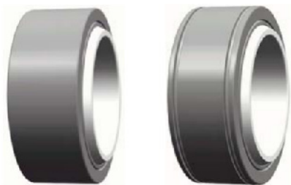
Massreihe: G / DIN 12240-1 Gleitpaarung: Stahl / PTFE Ausführung: wartungsfrei
