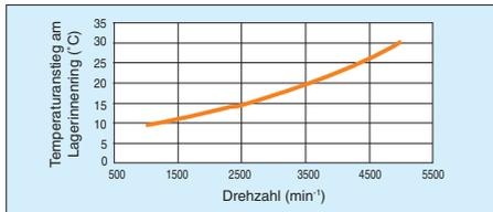
Abb. 13.13 Relation von Drehzahl zum Temperaturanstieg
