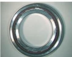
Das Lager mit der Hand drehen, und gleichzeitig die geeignete Last in Richtung des Kontaktwinkels anlegen, damit alle Innenbereiche ausreichend mit Fett versorgt werden.
