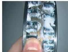
Schmier Sie Fett auf die Oberflächen der Rollen und verteilen Sie das Fett auf der Innenringseite (Außenring-), während die Rollen manuell weitergedreht werden.
